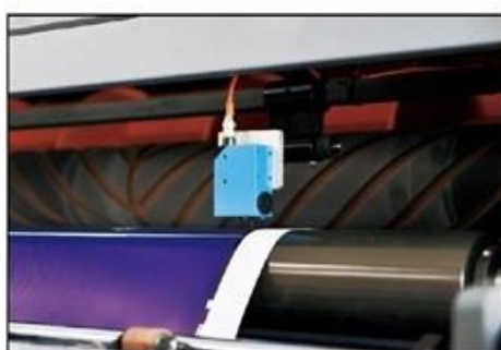
Fotoelektryczny system rozcinania zadrukowanej wstęgi - opcja
